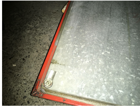
Schiuma contenente amianto come guarnizione per Monoblocco, Geotest
