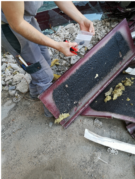
Plaque de façade avec enduit bitumineux contenant de l'amiante. Photo: C. Campoarmor, Arcadis Schweiz AG
