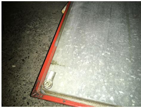
Asbest-Schaumstoff als Dichtung bei Monoblock, Geotest
