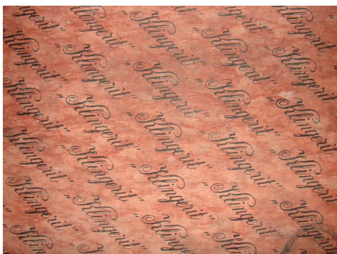
Klingerit-Dichtung rot mit Asbest Marke
